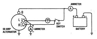
**CHECKING THE IC REGULATOR VOLTAGE**
